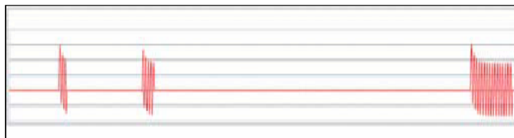
Figura 2.8 Magnitud de la corriente en un reconectador convencional [11]
