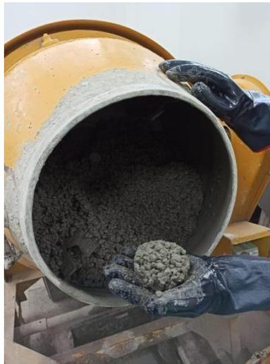
**Figura 2.3 Comprobación de consistencia de hormigón permeable (Autores)**
