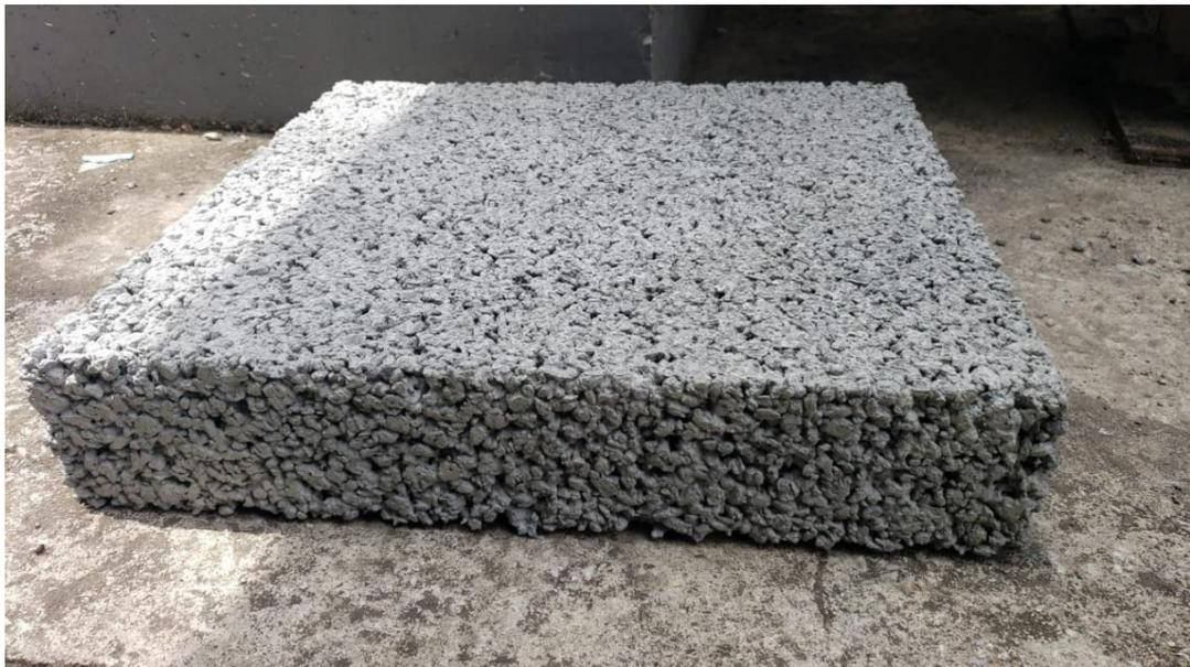
**Figura 1.15 Placa de Hormigón Permeable (Autores)**
