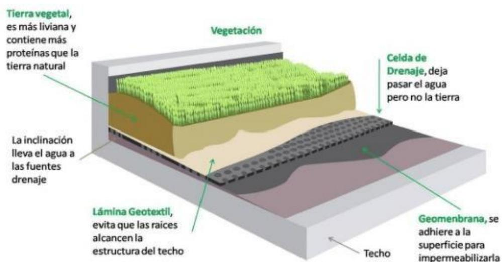
**Figura 4.4: Esquema de cubierta verde (Libélula, 2008)**
