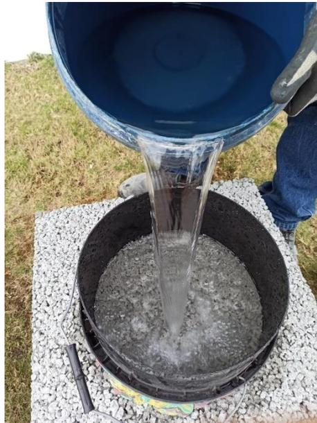
**Figura 3.1: Ensayo de penetración de agua a la placa de 15 [cm] de espesor y 15% de índice de vacíos (Autores)**
