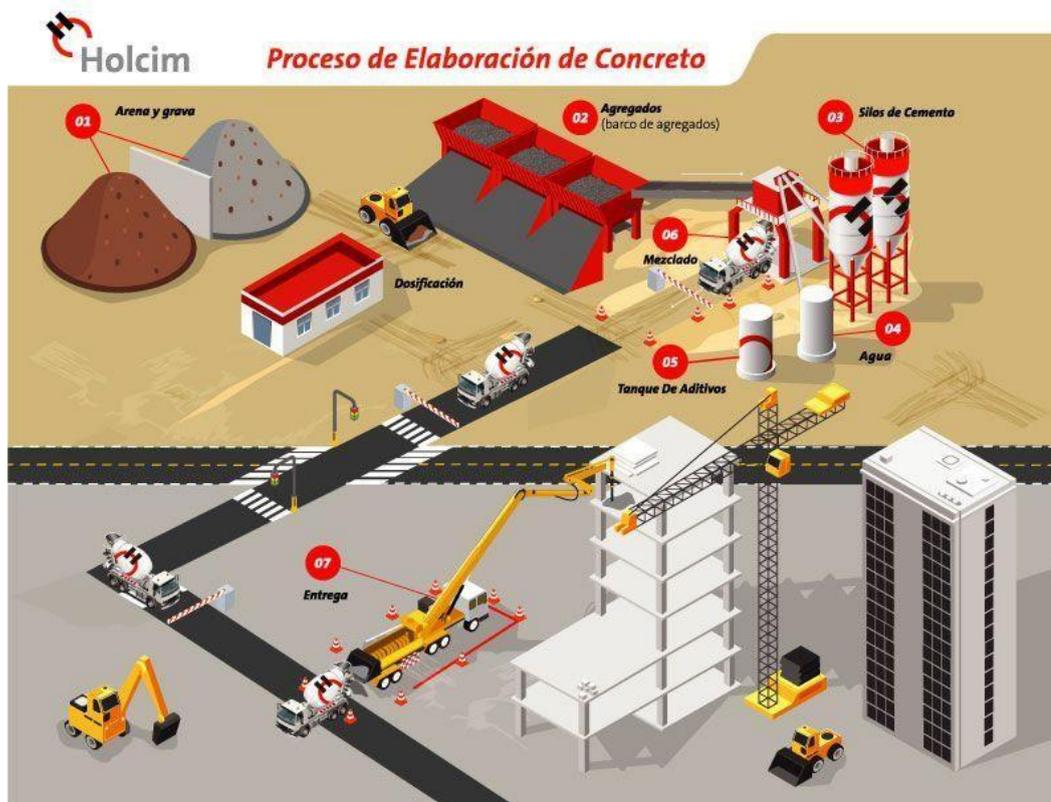
**Figura 1.10 Proceso de Elaboración del Concreto (Holcim México, 2021)**
