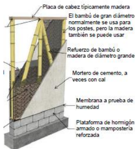
Ilustración 1.4 Muro de Bahareque Encementado
