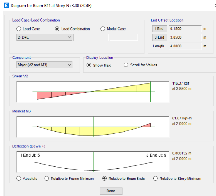
Ilustración 3.3 Diagrama de cortante y momento.
