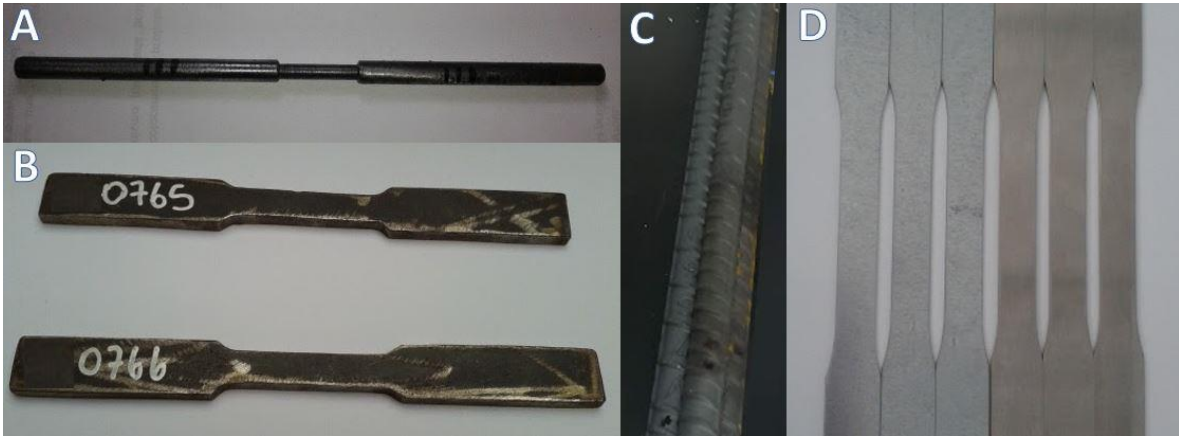
Figura 2.2 Probetas de tracción tipo: A-circular, B-plancha, C-barra y D-placa. Fuente: Elaboración propia
