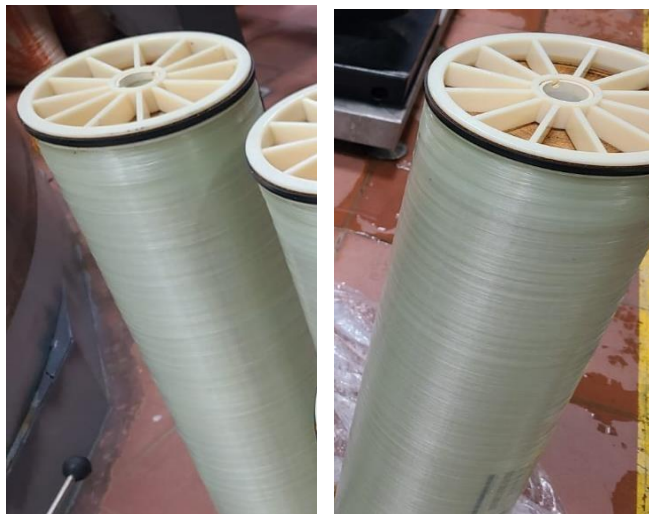
Figura 2. 30 Cartuchos de membranas de ósmosis nuevos luego de la mejora
