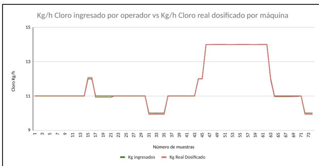
Figura 2.41 Gráfica de líneas de Kg/h Cloro ingresado por operador vs Kg/h Cloro real dosificado
