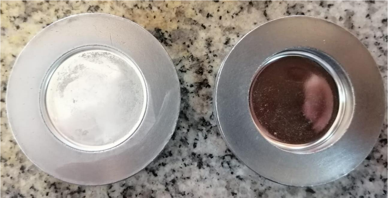
Figura 3.4 Diferencia del estado del anillo porta muestras del antes vs después
