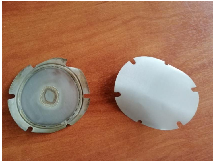
Figura 2.24 Malla sobresaturada vs malla nueva
