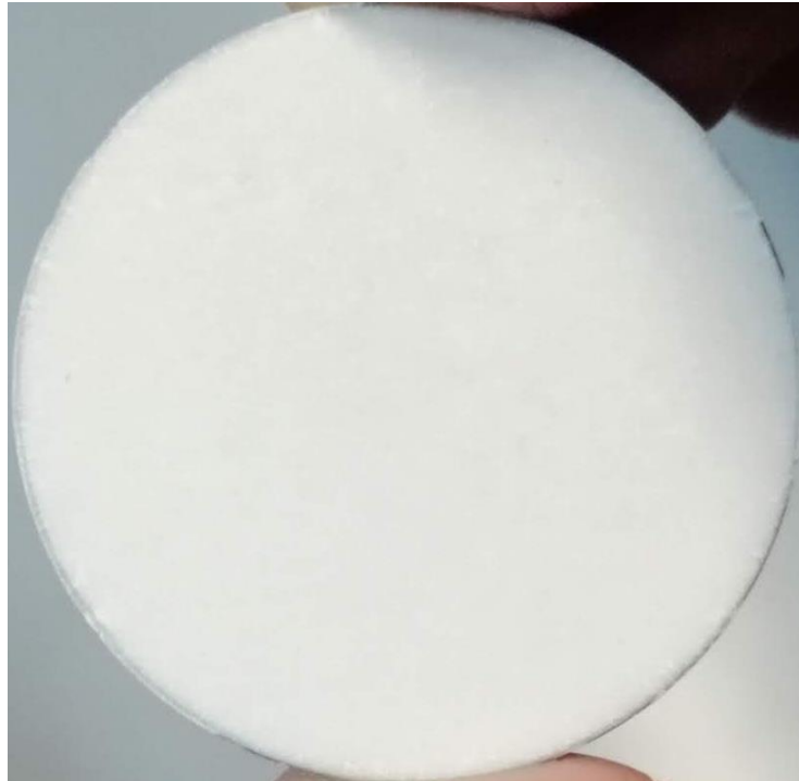
Figura 3.3 Pastilla prensada adecuadamente
