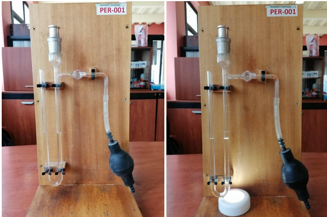
Figura 3.2 Implementación de iluminación en el permeabilímetro
