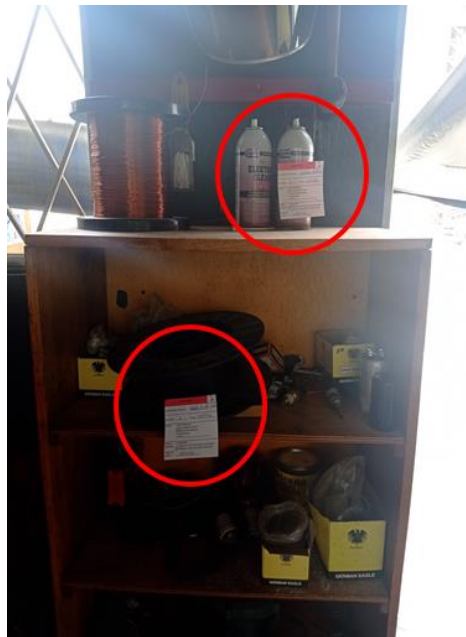
Figura 2.11 Aplicación de tarjetas rojas en modular de almacenamiento
