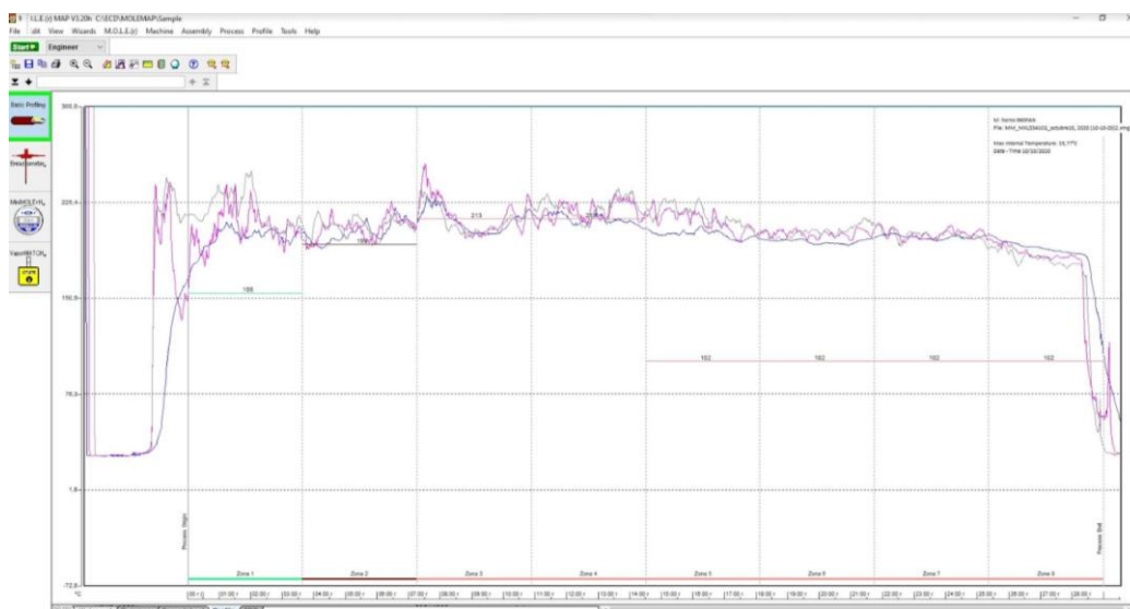
Figura 0.22 Comportamiento de temperaturas dentro del horno 05/octubre/2020 Elaborado por: MOLE MAP V3 - Autor
