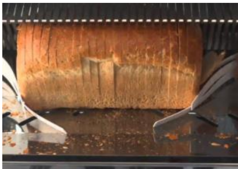
Figura 0.10 Rebanadora de pan molde con cuchillas desgastadas Elaborado por: Autor
