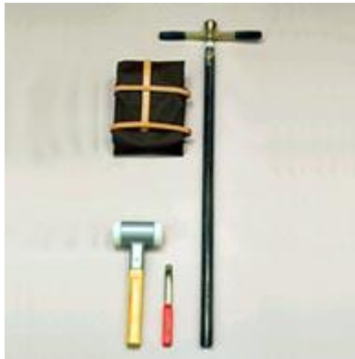
Figura 2.4. Set estándar para muestreos de hasta 1m de profundidad.
