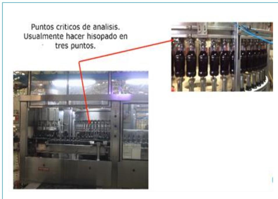
**Figura 2.38: Puntos a muestrear Llenadora. Elaborado por: Katty Garcés, año 2021.**
