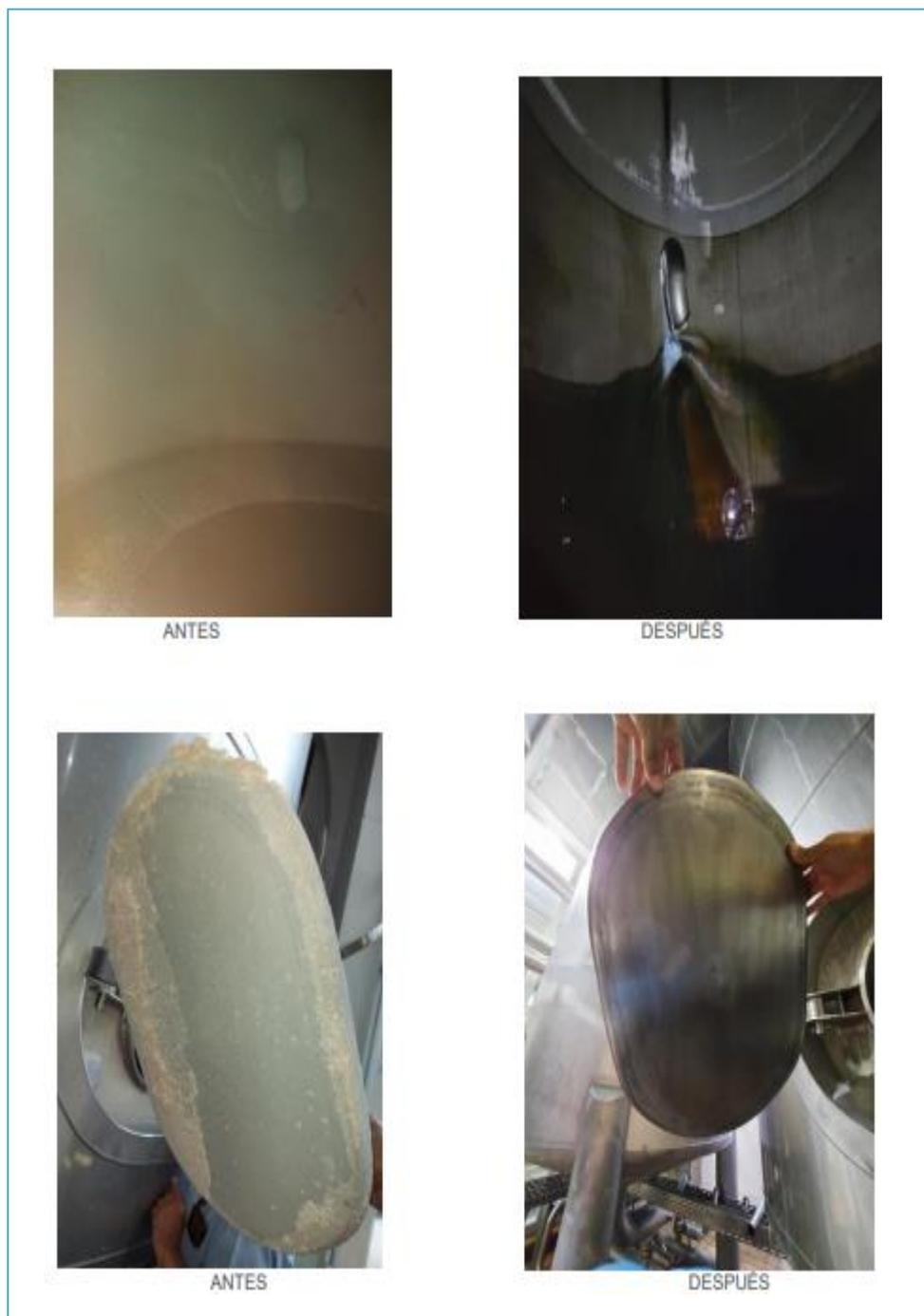
Figura 2.33: Antes y Después de la limpieza. Elaborado por: Katty Garcés, año 2021.
