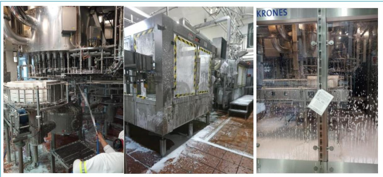
Figura 3.3: Limpieza Llenadora antes del CIP. Elaborado por: Katty Garcés, año 2021.
