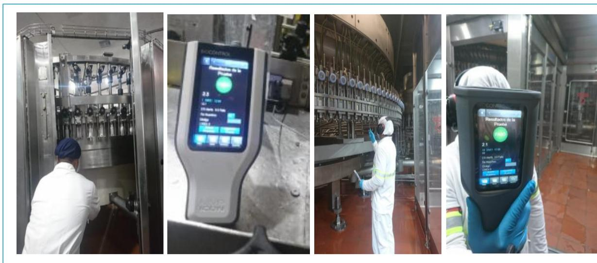
Figura 3.7: Liberación de línea ATP. Elaborado por: Katty Garcés, año 2021.
