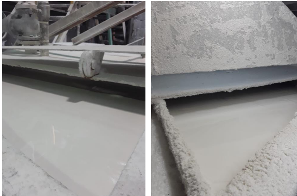
Figura 2.22: Mezcla homogénea y sin grumos de lechada de cal Fuente: Autoría propia
