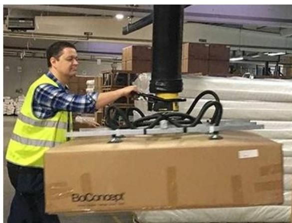
**Figura 4.5 Brazo manipulador neumático**
