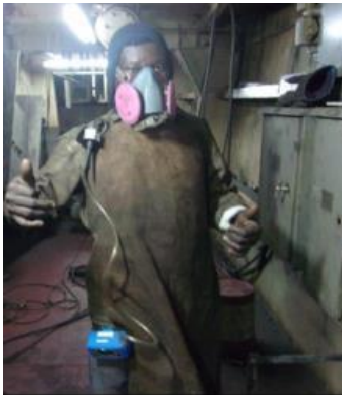
FIGURA 3.6. MEDICIÓN DE HUMOS METÁLICOS A TRABAJADOR.
