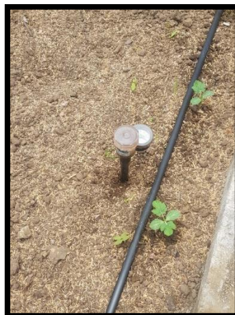
Figura 2.6 Tensiómetro instalado a 15 cm de profundidad de la cama de siembra
