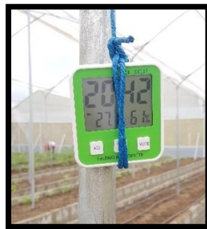
Figura 2.8 Sensor digital para medir temperatura y humedad relativa dentro del invernadero
