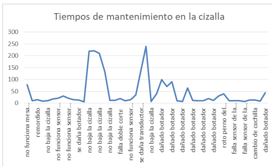
Figura 2.12. Tiempos de mantenimientos por diferentes causas
