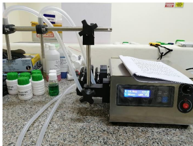
Figura 2.1 Llenadora de bomba peristáltica
