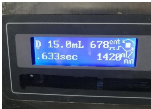
Figura 7.6 Configuración de fábrica de llenadora
