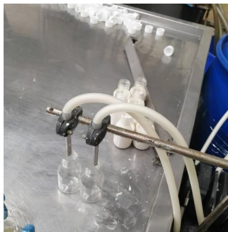
Figura 19.18 Uso de palanca en traslado de frascos
