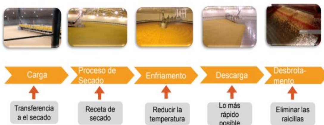
Figura 3.2 Proceso de secado de la cebada Fuente: Charla técnica de secado (ABInBev, 2019)
