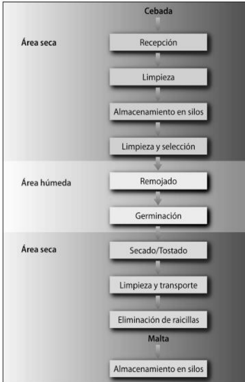
Figura 2.1 Proceso de elaboración de la malta
