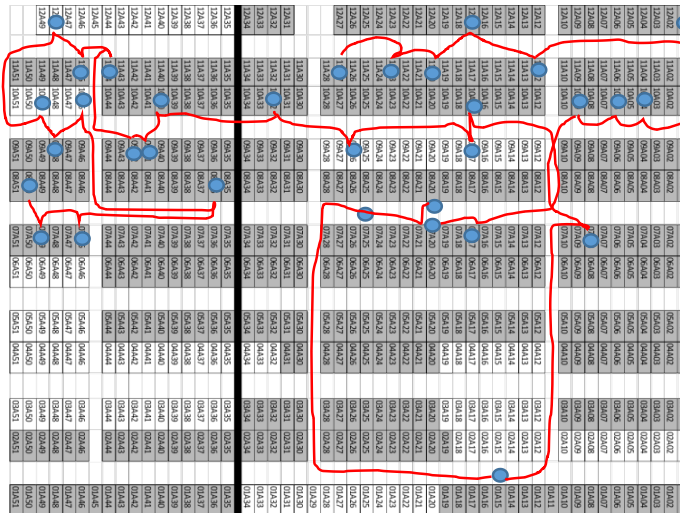
Figura 2.23: Recorrido del Operario en una Orden Edward Mendoza – Jennifer Castro
