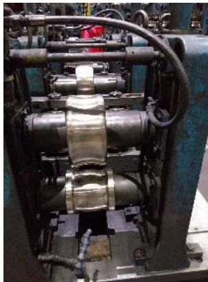
Figura 2.17 Problemas de armado en paso de quebradores
