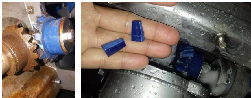
Figura 3.41 Piñones helicoidales de sacrificio gastados
