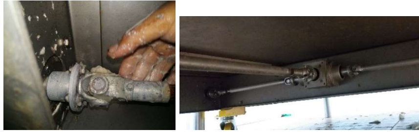
Figura 3.57 Limpieza y lubricación de cardán
