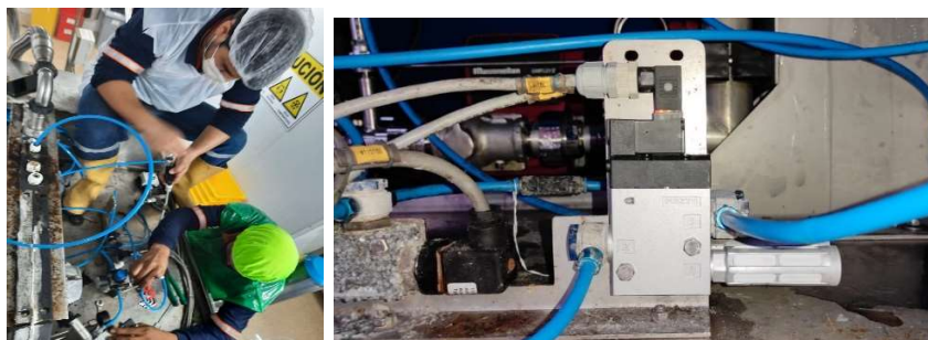
Figura 3.52 Cambio de solenoides completos
