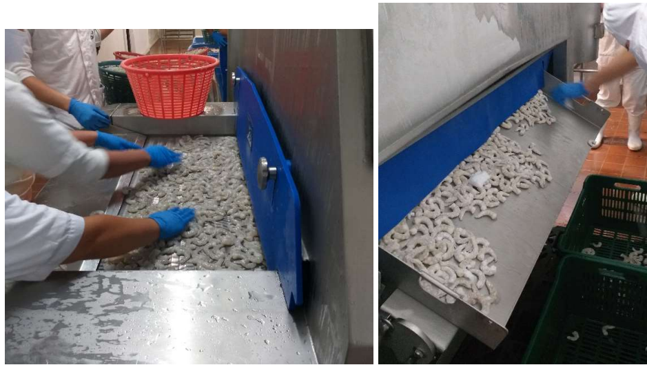
Figura 2.4 Entrada y salida de camarón en el proceso de congelamiento (Fuente: Archivos Criogenia)
