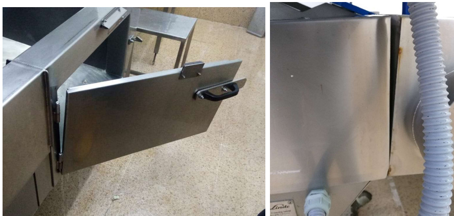
Figura 3.44 Daño en estructura perimetral de túneles
