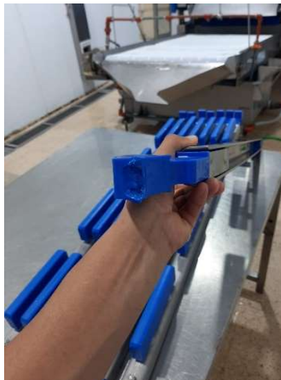
Figura 3.16 Limpieza de soportes de banda sobre mesa asignada
