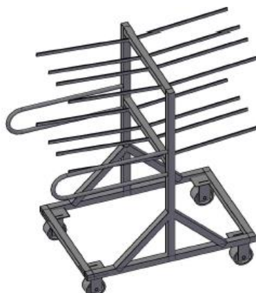
FIGURA 3.8 DISEÑO DEL CARRO PARA ALMACENAR PARRILLAS TERMINADAS
