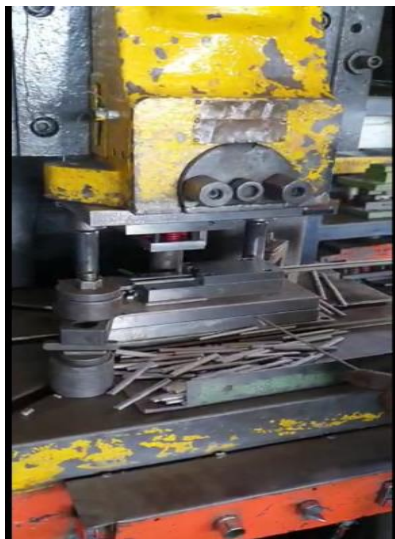
FIGURA 3.4 TROQUEL PARA CORTE DE LA VARILLA (Fuente: Departamento de manufactura)
