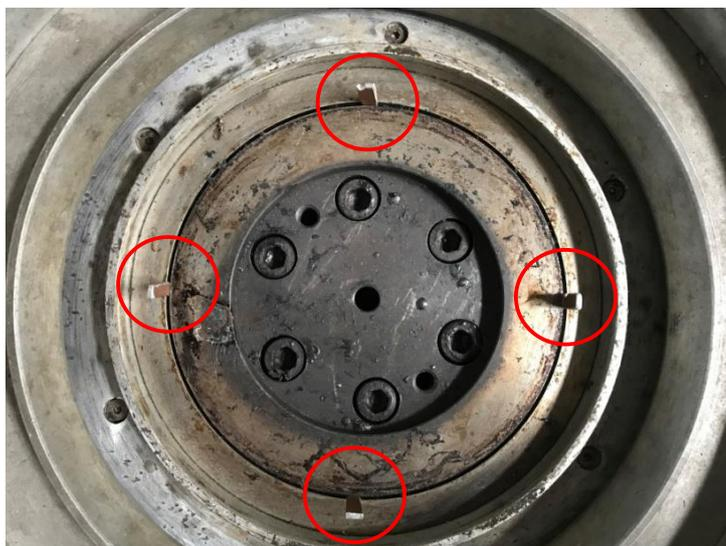
FIGURA 2.27 CALIBRADORES DE MOLDE
