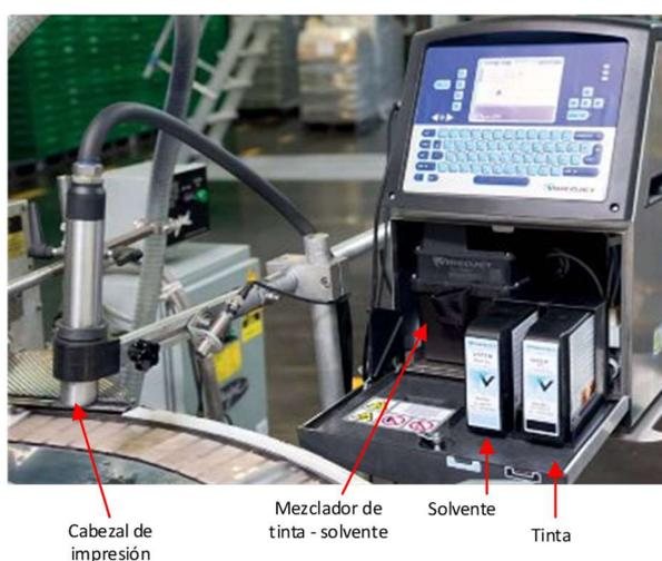
**FIGURA 4.10 OPERACIÓN DE UN EQUIPO DE CODIFICACIÓN INKJET**
