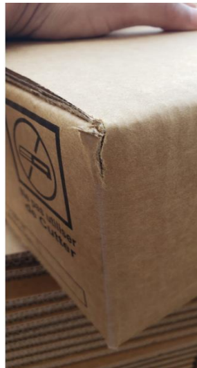
Figura 3.43 Cajas con defecto de descuadre
