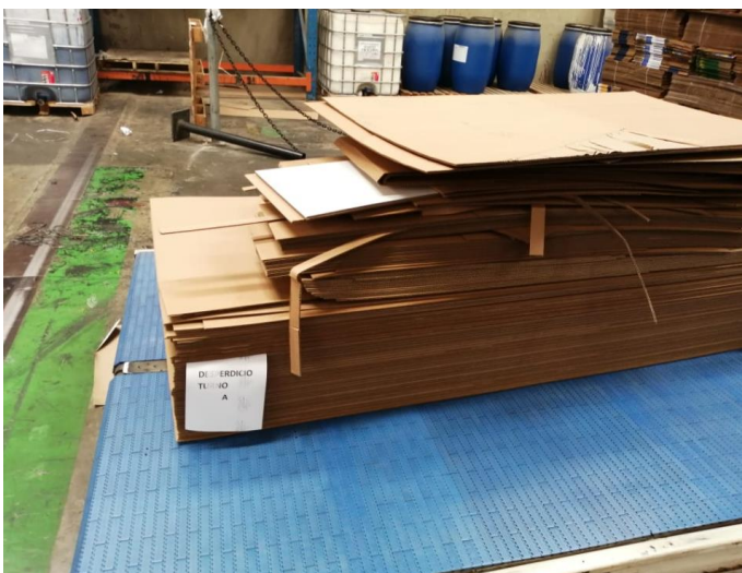
Figura 3.14 Desperdicio de papel en el área de Corrugadora denominado no conforme
