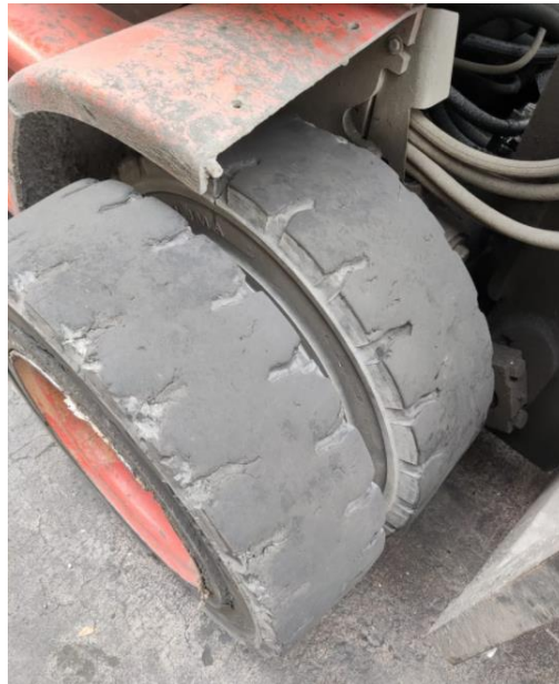
Figura 3.32 Llantas lisas en montacarga de clamp (Fuente: Investigación de campo)
