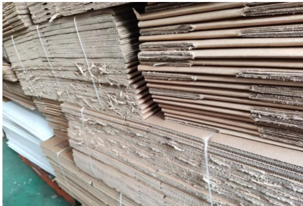
Figura 3.42 Cajas con defecto por corte defectuoso
