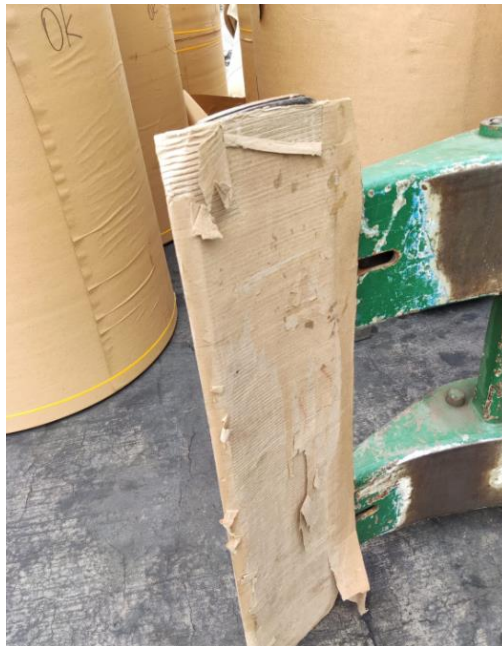
Figura 3.33 Tenazas de montacarga no adecuadas (Fuente: Investigación de campo)
