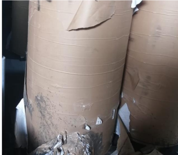
Figura 3.35 Bobinas llegan con golpes (Fuente: Investigación de campo)
