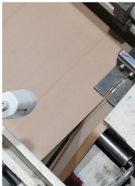
Figura 3.24 Desperdicio de papel en el área de Planificación denominado TRIM
