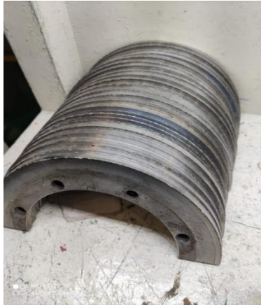
Figura 3.44 Cuchillas ranuradoras gastadas
