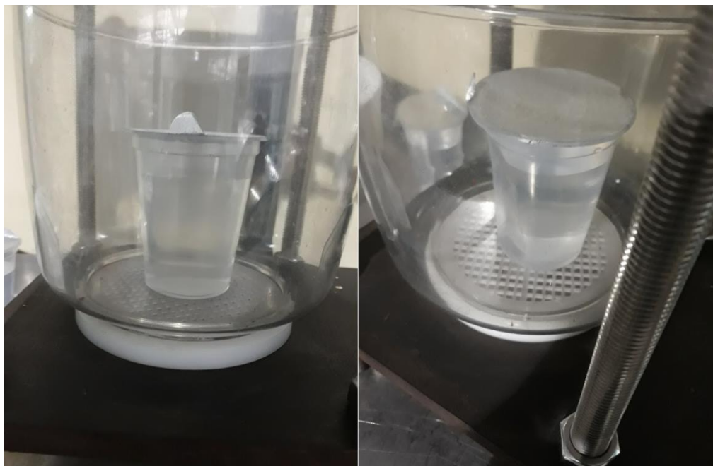
FIGURA 3.15: ENSAYO DE COLAPSAMIENTO DE ENVASES.
