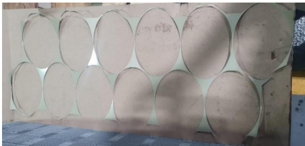
FIGURA 2.11 LÁMINA MAL TROQUELADA (Fuente: elaboración propia)
