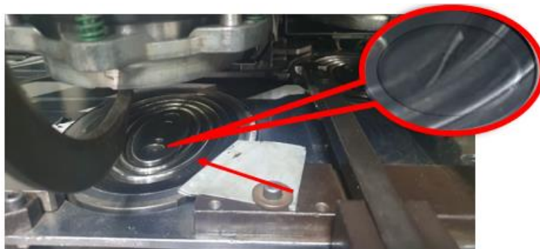
FIGURA 2.15 PRESENCIA DE ESQUELETO EN EL TROQUEL (Fuente: elaboración propia)
