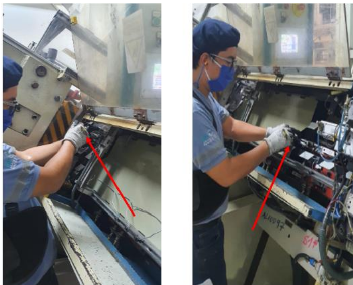
FIGURA 2.19 CALIBRACIÓN DE LA TROQUELADORA (Fuente: elaboración propia)
