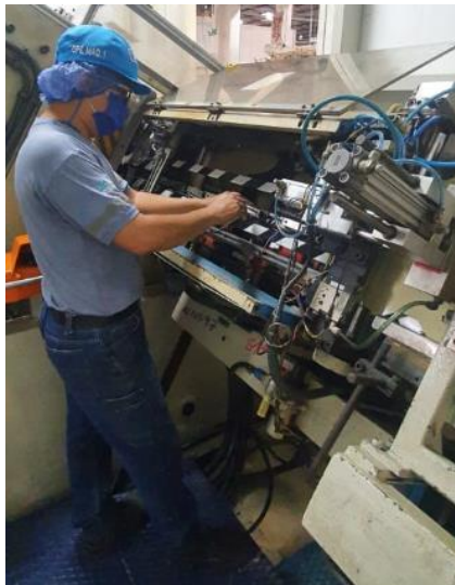
FIGURA 2.10 CALIBRACIÓN EN LA TROQUELADORA (Fuente: elaboración propia)
