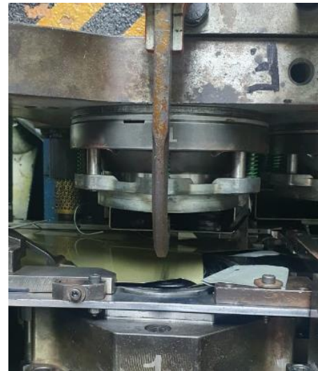
FIGURA 2.10 CALIBRACIÓN EN LA TROQUELADORA (Fuente: elaboración propia)
