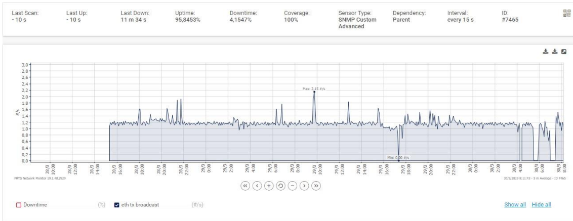
Figura 5.19 Análisis de tráfico por PRTG Network Monitor - Con VLAN
