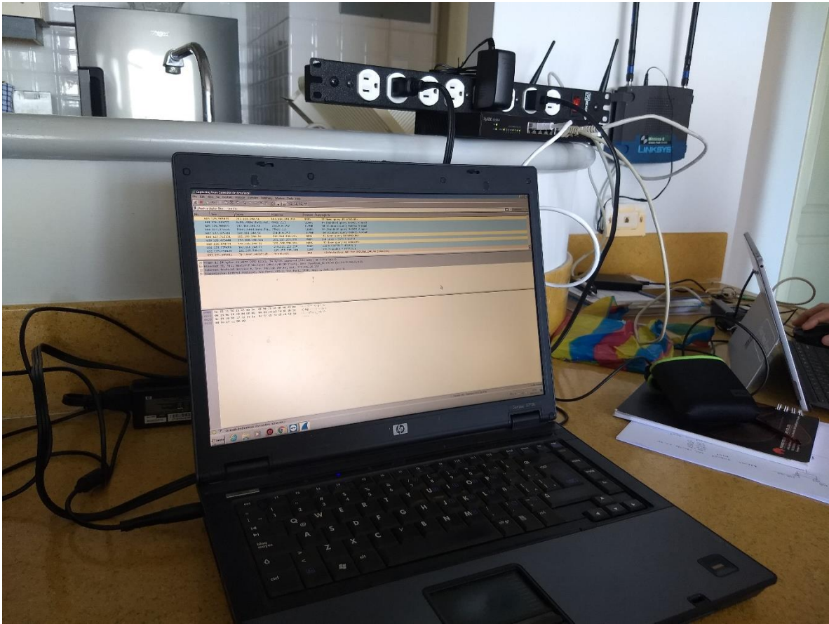
Figura 5.14 Medición de tráfico y broadcast mediante Wireshark en punto residencial
