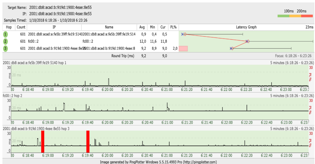
Figura 4.9 Gráfica resultante de la transmisión de Paquetes ICMP sobre IPv6 usando técnica por default FIFO
