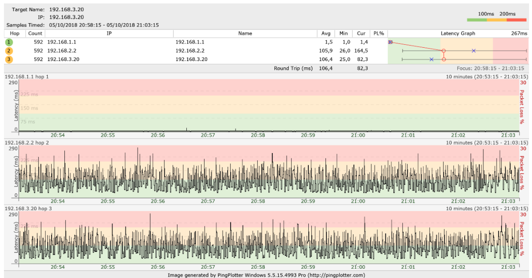
Figura 4.18 Gráfica resultante de la transmisión de Tráfico WEB utilizando la Técnica de QoS PQ
