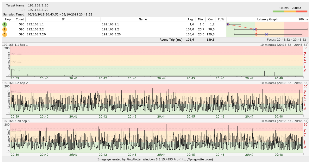
Figura 3.10 Captura de tráfico generado por un tipo de tráfico desde el Punto A de la red al Punto B
