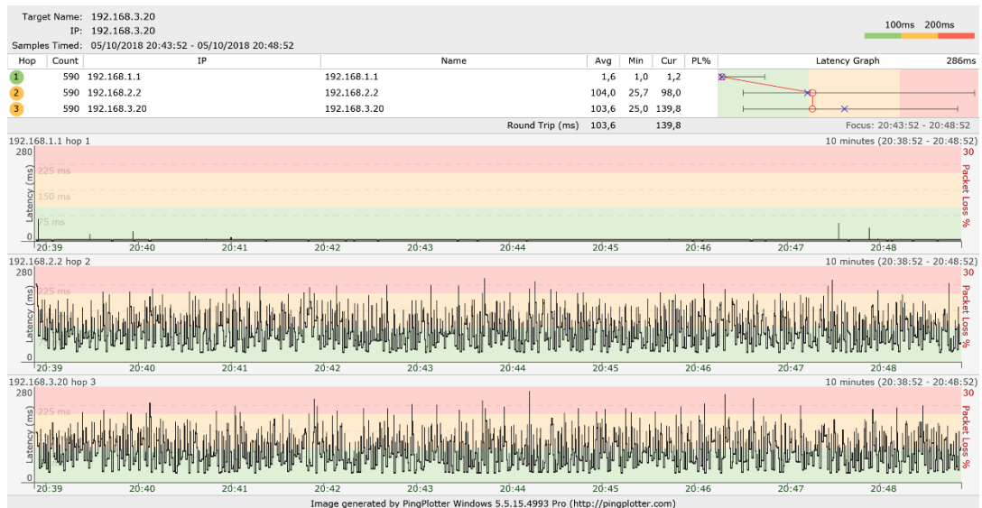
Figura 4.19 Gráfica resultante de la transmisión de Tráfico WEB utilizando la Técnica de QoS WFQ
