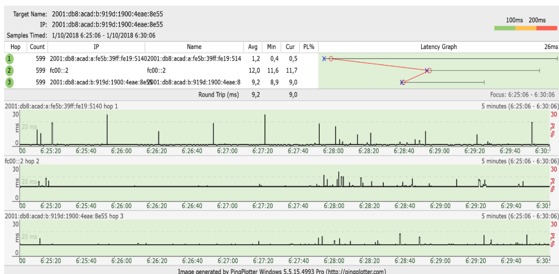
Figura 5.3 Gráfica resultante del ajuste en la configuración de LLQ para la transmisión de Tráfico de VoIP
