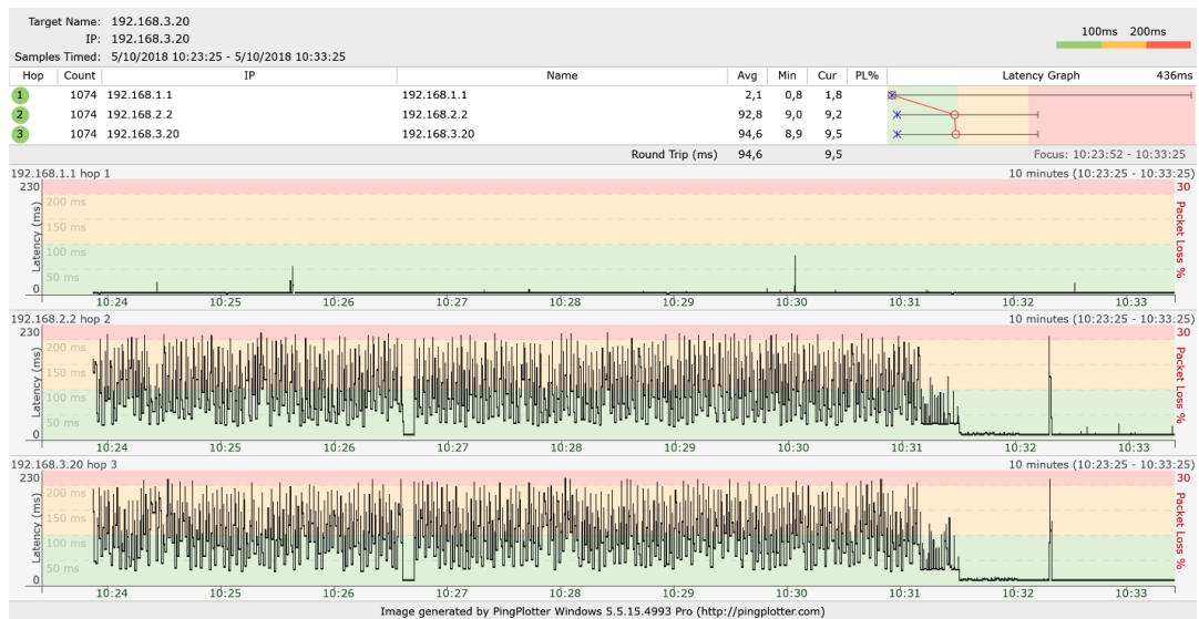
Figura 4.20 Gráfica resultante de la transmisión de Tráfico WEB utilizando la Técnica de QoS LLQ
