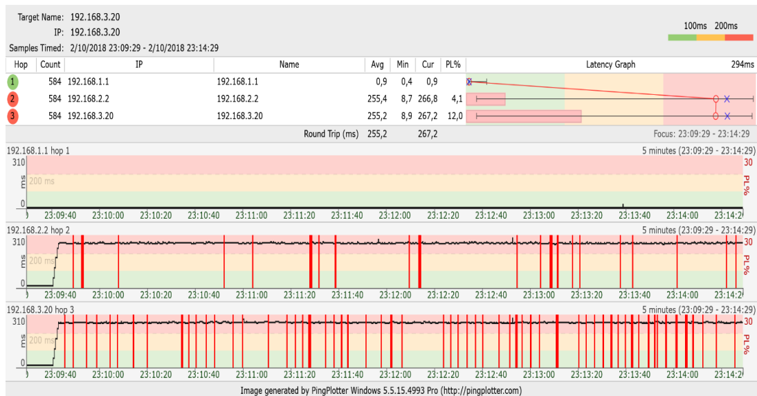
Figura 4.16 Gráfica resultante de la transmisión de VoIP utilizando la Técnica de QoS LLQ
