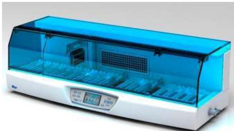
Figura 1.6 Máquina de tinción lineal [16]
