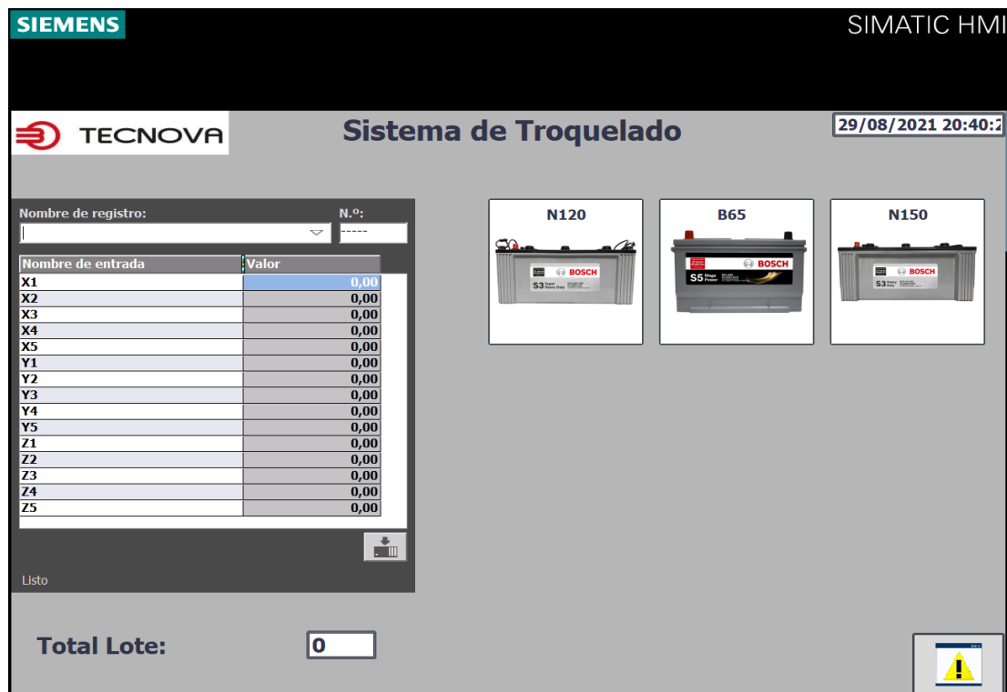
Figura A.27 Pantalla inicial del panel HMI.
