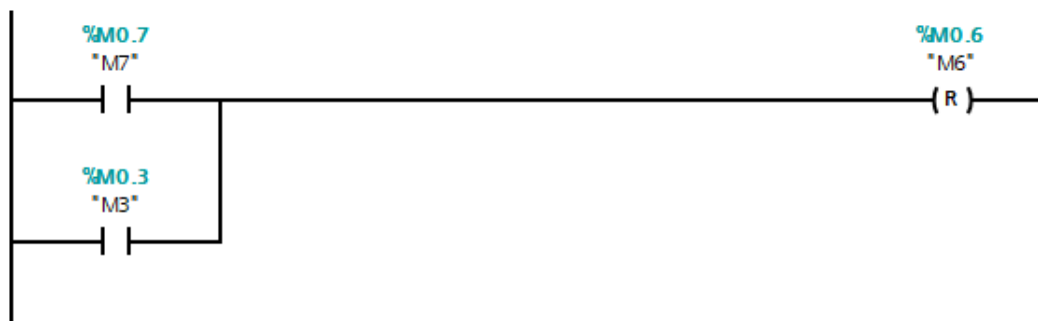
Figura A.17 Estado M6 en programación Ladder.
