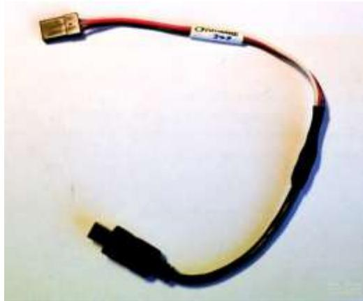
**Figura C. 2 Cable de comunicación Pixhawk [47].**
