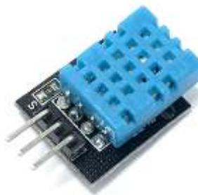
**Figura C. 3 Sensor de humedad DHT11 [48].**
