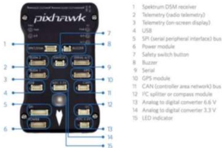
Figura B. 2 Puertos del Controlador de vuelo Pixhawk [40].
