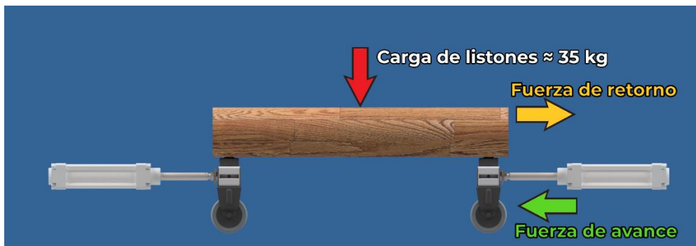
Figura 2.22 Morfología de pistones y carriles con carga de listones.
