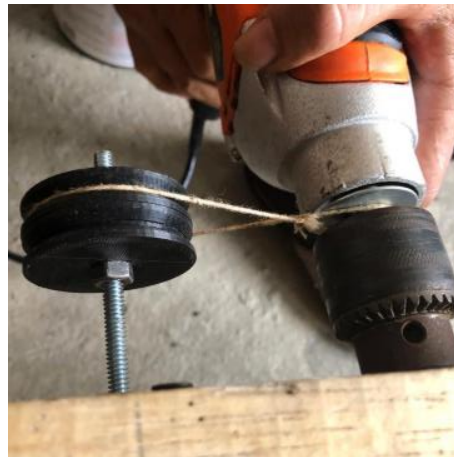
Figura 2.4 Acoplamiento de motor de taladro con transmisión por polea para los rodillos del mecanismo
