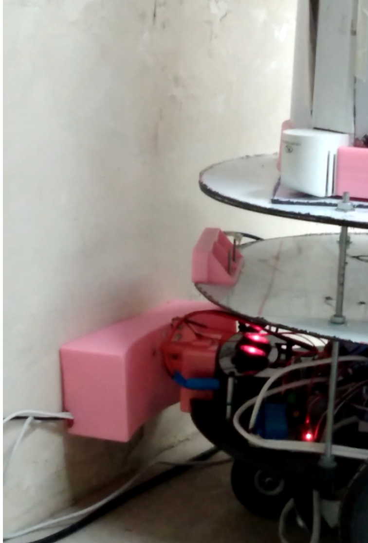
Figura 3.34 CoviBot completamente ingresado en la estación de recarga.
