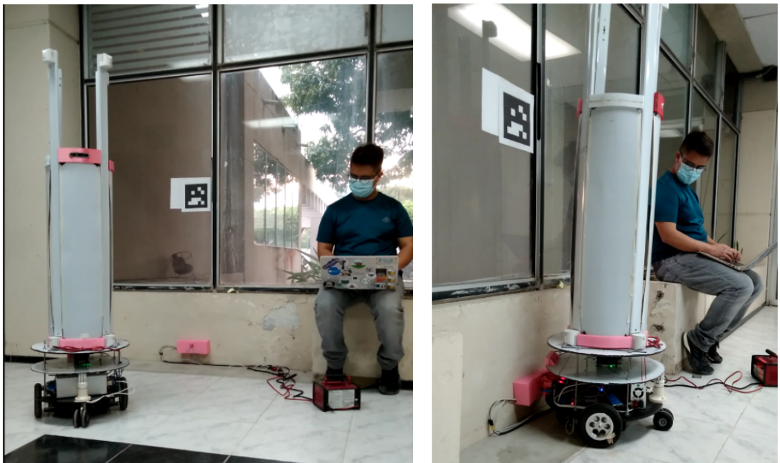
Figura 3.33 Prueba de auto recarga en el Edificio 3A.
