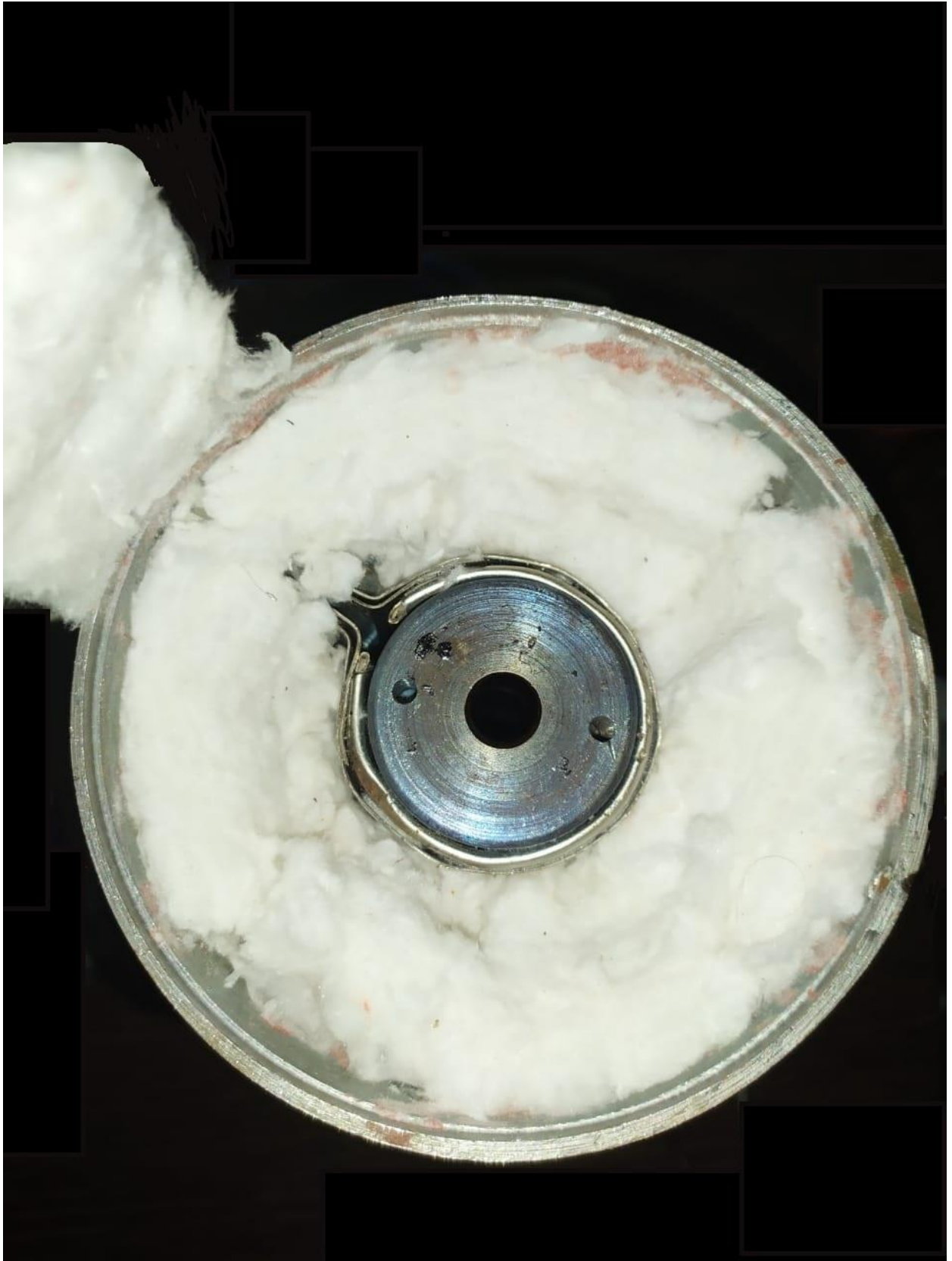
Figura 13-G: Ensamble del material aislante [Elaboración propia].
