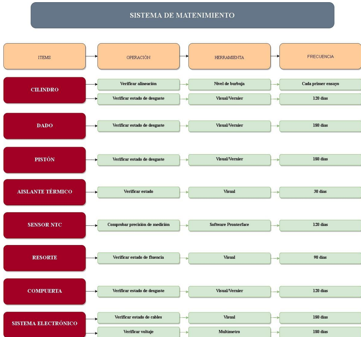
Figura 3.17: Sistema de mantenimiento [Elaboración propia].
