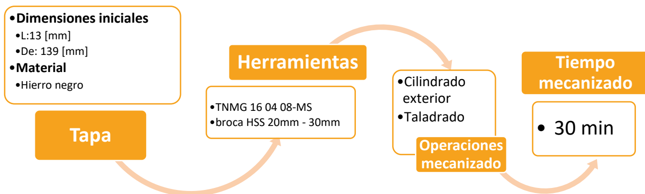
Figura 2.26: Secuencia para realizar proceso de mecanizado de la Tapa [Elaboración propia].
