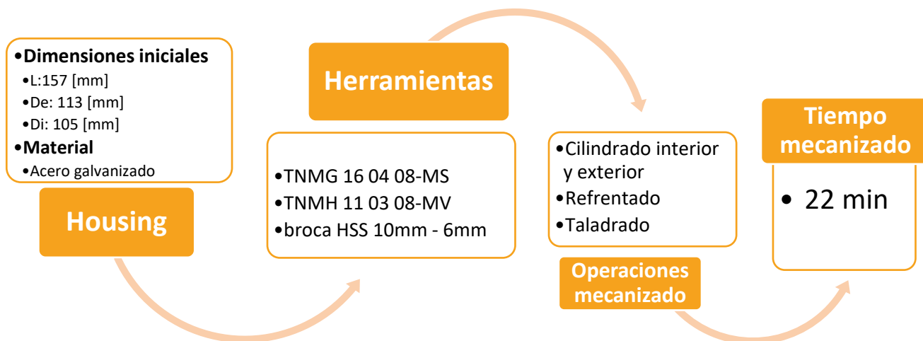
Figura 2.25: Secuencia para realizar proceso de mecanizado del Housing [Elaboración propia].
