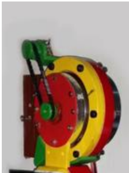
Figura 2.2. Potenciómetro acoplado a la cadera izquierda
