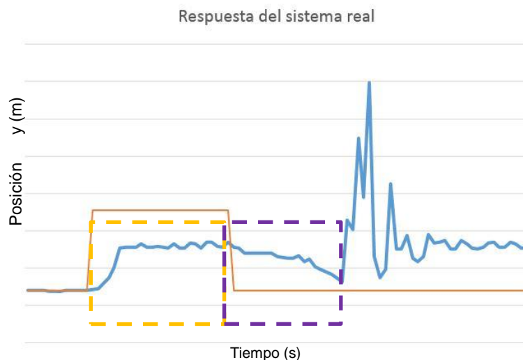
Figura 4.8: Respuesta del sistema, aplicación de fuerza magnética.
