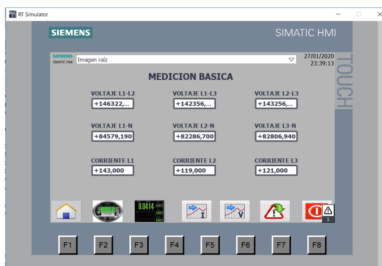
Figura 3.13: Pantalla de medición de voltajes y corrientes
