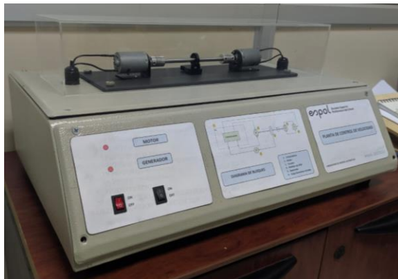
Figura 5.1 Fotografía de la planta didáctica de velocidad de un motor DC.
