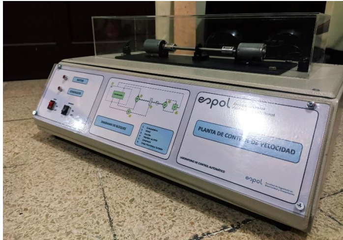
Figura 3.24 Planta de control de velocidad de un motor DC.
