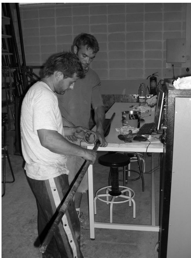
Figura 2.16. Aplicación de la interfaz antiadherente de los APR ensayados por Palazzo et al. (2009)
