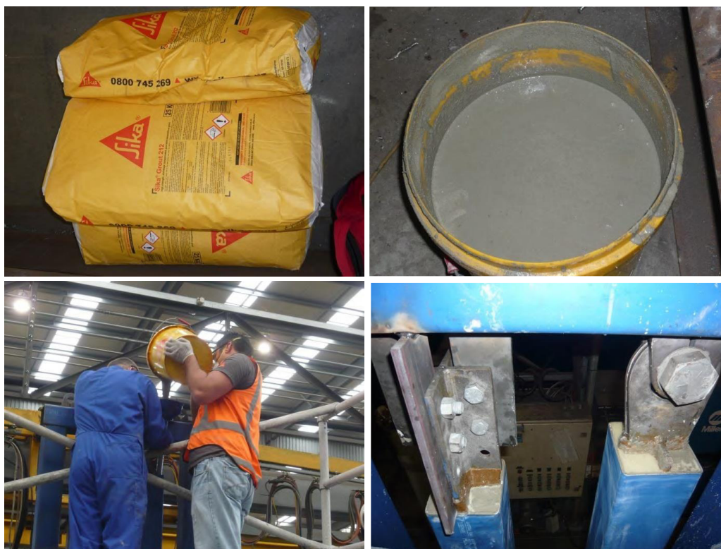
Figura 2.22. Mortero, Sika Grout 212, empleado en los APR desarrollados por Wijanto (2012)
