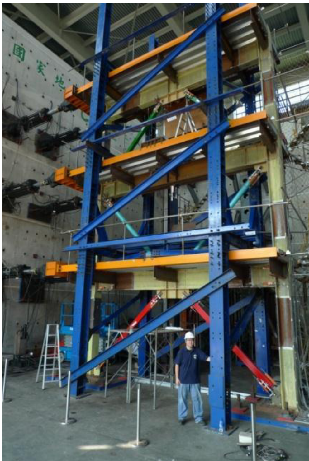
Figura 5.13. Fotografía de un espécimen de un ensayo de APR en subestructura real (Lin, et al., 2013)
