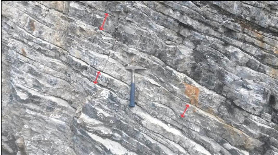
**Figura 37** Detalle de la separación de juntas en la EGM 4. Donde la separación de juntas mayormente es menor a 20 cms.
