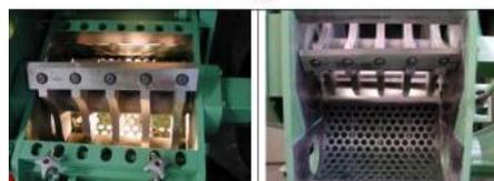
En resumen, el proceso de “cribatura”, es la separación granulométrica del caucho, de las fibras textiles. **Fuente:** Grupo Gercons Colombia.
