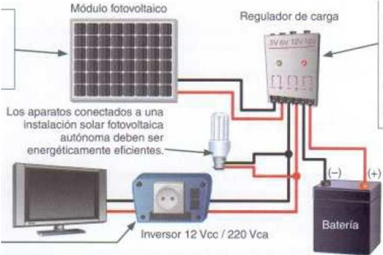
Figura 1.2. Elementos de una Instalación Fotovoltaica
