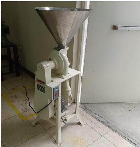
**Figura A.8** Proceso de molienda y tamizado de las cáscaras de naranja secas [Elaboración propia]
