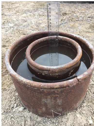
Figura 2.3 Medición de la infiltración del suelo con doble anillo.
