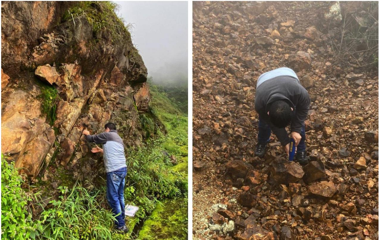
**Figura 2.8.** Izquierda elección del bloque a ensayar; derecha prueba de rebote esclerómetro (Yáñez, 2021).
