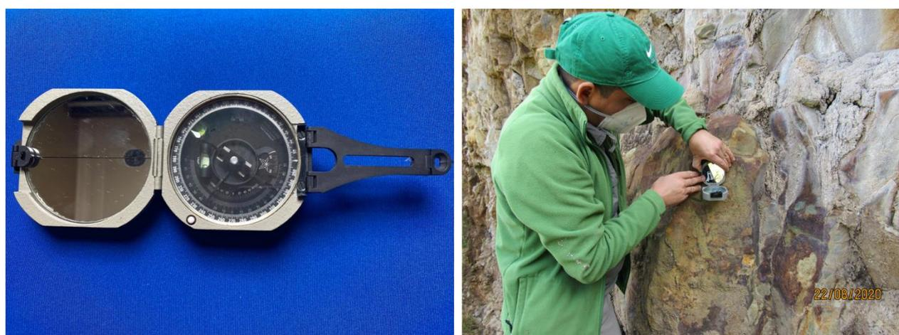
**Figura 2.1.** Medición mediante brújula de la orientación de un talud (Yáñez, 2021).
