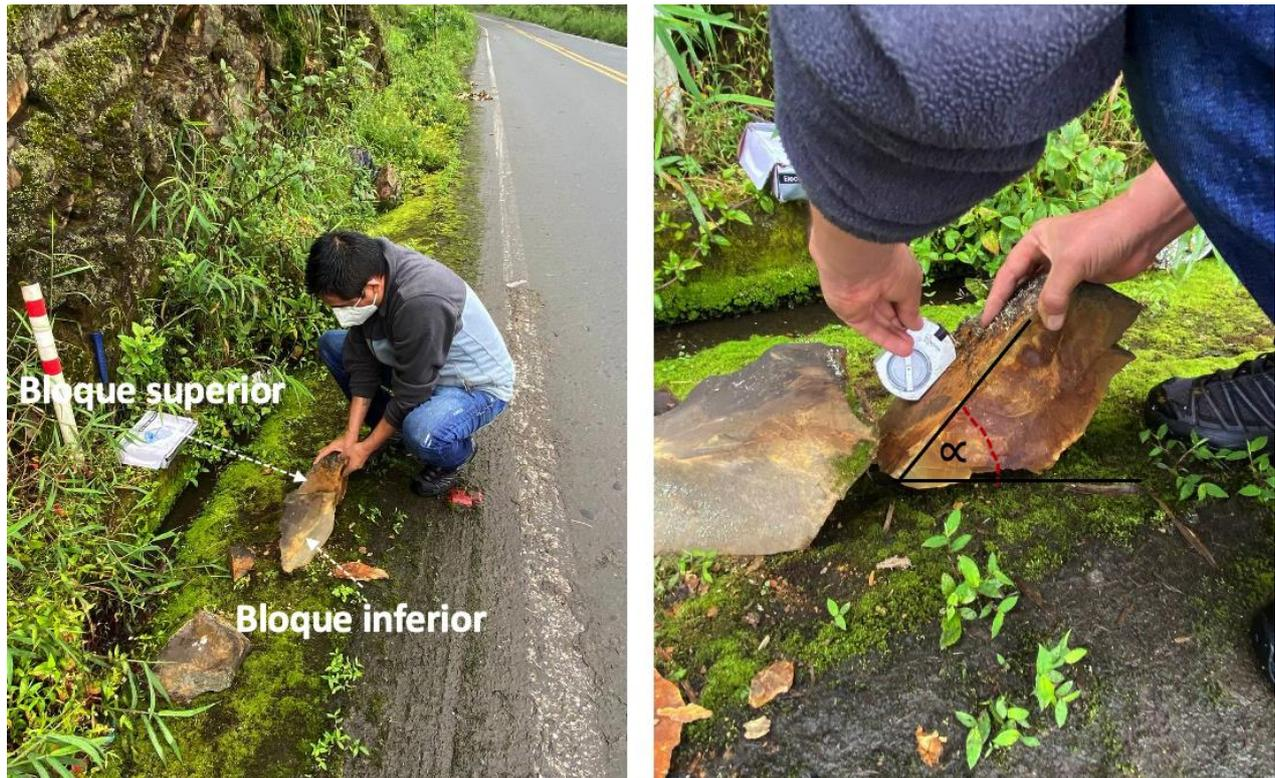
**Figura 2.10.** Izquierda deslizamiento del bloque superior; derecha lectura del ángulo de inclinación (Yáñez, 2021).
