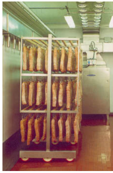
FIGURA 3.16: Cámara de secado – maduración
