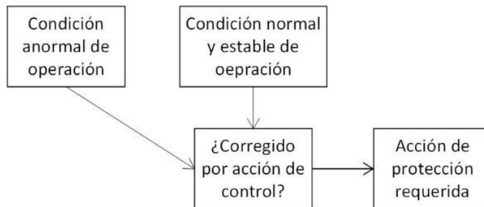
Figura 1.1. Concepto básico de la coordinación entre el control y protecciones de un generador (Pajuelo, 2015)
