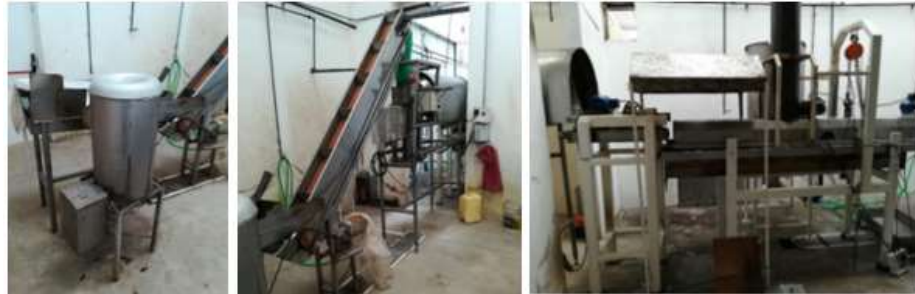
Figura 3 De izquierda a derecha se muestran: equipo para pelado de papas, transportador vertical y etapa de fritura. [5]
