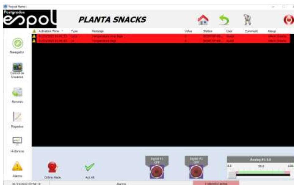
Figura 60 Ventana de alarmas del Sistema SCADA
