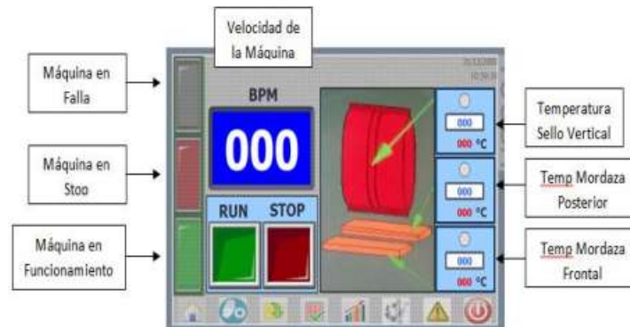
Figura 5 HMI implementada en el proceso de la empresa YUPI [6]
